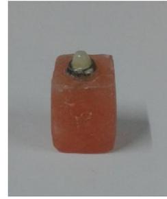
صورة(1) العينة المعدنية الخزفية صورة(2) العينة أثناء اختبار القص صورة(3) العينة بعد انفصال الخزف
